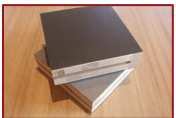
Ploče namijenjene suhim prostorima. Njihovu osnovu čine materijali na bazi drveta. HDF ploče vlaknatice u kombinaciji s papirnatim saćem ili u kombinaciji sa punim drvetom (letvice smreke) i furnirom drveta topole ili fromage-a.
