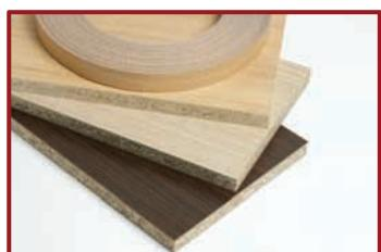
Osnovu ovog proizvoda (materijala) čini troslojna vlagootporna iverica V 100 debljine 28 mm. Izrađeno je sa specijalnim ljepilima koja u dodiru s vodom sprječavaju znatnije upijanje vode – bubrenje materijala. Ipak, kao što sam naziv kaže, ovaj materijal nije vodootporan nego vlagootporan, što znači da se može koristiti u područjima povišene vlage zraka, ali nikako u područjima sa čestim ili konstantnim dodirom s vodom.
