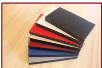
Kompakt ploča je materijal bez premca u projektiranju i gradnji sanitarnih, bazenskih i sličnih prostora koji su opterećeni teškim uvjetima vlage, pojačanog održavanja i čišćenja, vandalizma i dr. Ovo je materijal koji će većina nas na prvi pogled usporediti s bakelitom, što u osnovi možemo reći da je točno, odnosno vrlo slično. Kompakt ploča je materijal dobiven prešanjem (pod utjecajem
