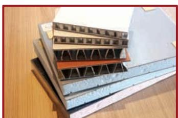
Vodootporne ploče koje odlikuje fantastičan omjer izuzetne čvrstoće i vrlo male specifične težine te izuzetna fleksibilnost s obzirom na mesta i načine ugradnje kao i korištene površinske materijale. Kao što im ime kaže: sastavljene su po sandwich sistemu iz srednjeg (unutarnjeg) sloja: poliuretan, saćasti PVC, saćasti aluminij te vanjskih dekorativnih slojeva: HPL laminat, eloksirani, plastificirani ili farbani aluminij, prirodni ili kaširani fine-line furnir. Završni rubovi su
